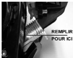
4. Tournez le bouchon du réservoir d'huile dans le sens inverse des aiguilles d'une montre et déposez-le. Le niveau d'huile doit se trouver au milieu du filetage dans la partie inférieure du trou de remplissage (voir ci-dessus).
